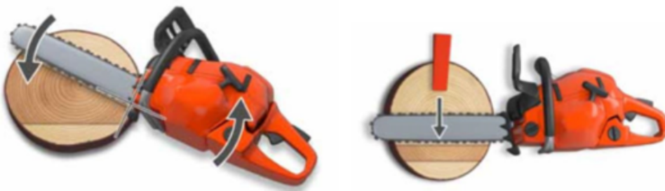
ภาพที่ 20 การล้มไม้ที่มีขนาดเล็กกว่าความยาวใบเลื่อย (ภาพ: WWW.HUSQVARNA.COM)
