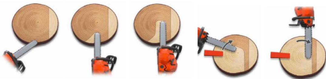
ภาพที่ 21 การล้มไม้ที่มีขนาดเป็น 2 เท่าของความยาวใบเลื่อย (ภาพ: WWW.HUSQVARNA.COM)
