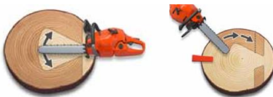
ภาพที่ 22 การล้มไม้ที่มีขนาดมากกว่า 2 เท่าของความยาวใบเลื่อย (ภาพ: WWW.HUSQVARNA.COM)
