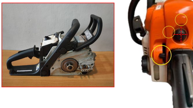
ภาพที่ 10 การเปิดฝาครอบกรองอากาศ
